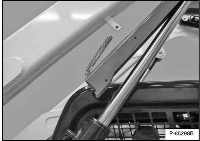
Suba los brazos un poco. El resorte subirá el dispositivo de soporte retirándolo de la biela del cilindro de elevación [Figura 191]. Baje los brazos elevadores. Detenga el motor.
