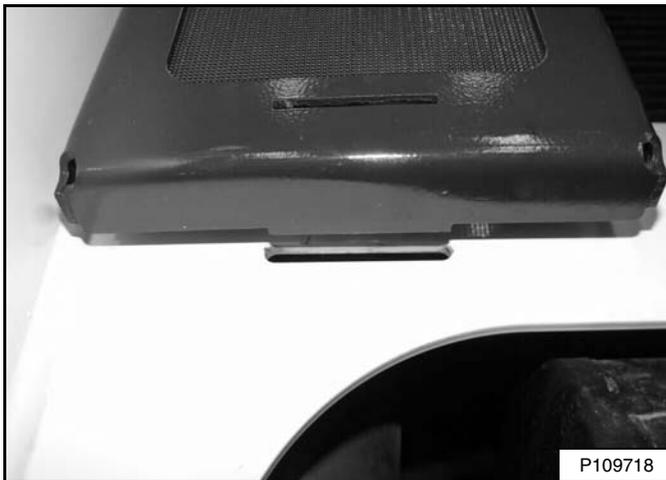
Alinee las lengüetas traseras de las dos cubiertas laterales con las ranuras del bastidor del cargador y bájelas [Figura 222]. (Se muestra el lado izquierdo).
