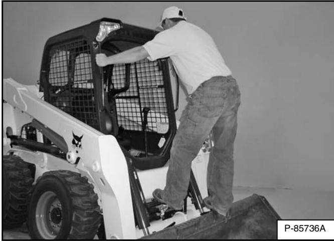
Use los escalas del cucharón o aditamento, las palancas de agarre y los peldaños de seguridad (en el brazo y el bastidor del cargador) para ingresar y salir del cargador, manteniendo 3 puntos de contacto todo el tiempo [Figura 106]. No salte.
