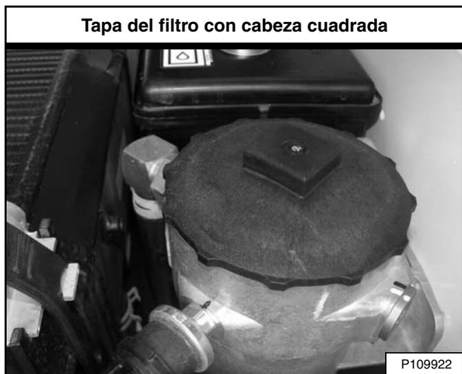
Este modelo tiene una cabeza cuadrada en la tapa del filtro **[Figura 285]**. (Ver Cómo desinstalar y reemplazar el filtro hidráulico / hidrostático (tapa del filtro con cabeza cuadrada) en la página 170.)
