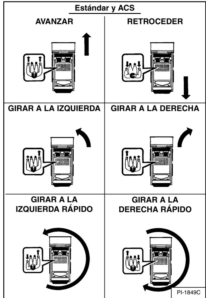
Las palancas de dirección controlan el avance, el retroceso y el giro del cargador [Figura 59].
