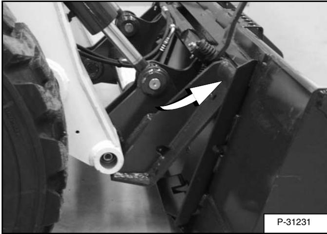
Maneje el cargador lentamente hacia adelante hasta que el borde superior del Bob-Tach quede completamente debajo de la pestaña superior del bastidor de fijación del cucharón [Figura 146] (o de otro aditamento).
