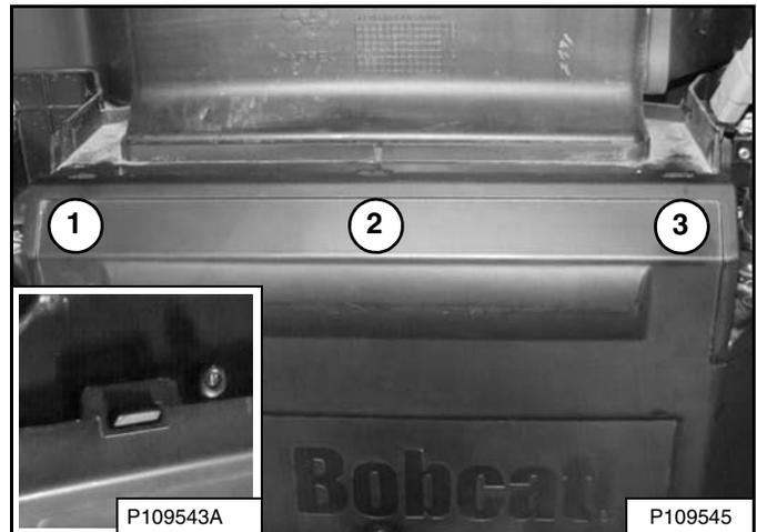
2. Empuje la cubierta hacia arriba tres lugares (ítem 1, 2 y 3) hasta que las ranuras se encajen en su lugar. Esta ranura (interior) [Figura 235] está ajustada correctamente.
