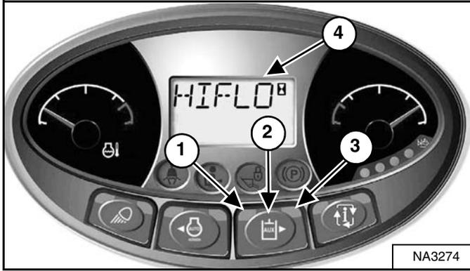
Oprima el botón (ítem 2) una vez para activar los auxiliares hidráulicos. La lámpara (ítem 1) [Figura 96] se ENCIENDE.
