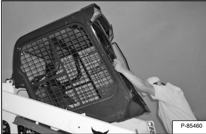
Suba las palancas de agarre y el extremo inferior de la cabina del operador [Figura 199] lentamente hasta que la cabina quede completamente arriba y el mecanismo de seguridad se enganche.
