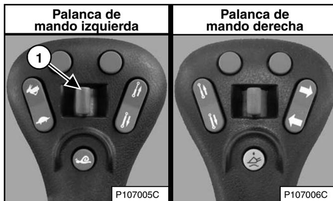
Mueva el interruptor de los auxiliares hidráulicos traseros (ítem 1) [Figura 94] o [Figura 95] hacia la derecha o izquierda para cambiar la dirección del caudal del fluido auxiliar hidráulico hacia los acoples rápidos traseros [Figura 93]. (POR EJEMPLO: subir y bajar estabilizadores traseros). Suelte el interruptor para detener el caudal del fluido.
