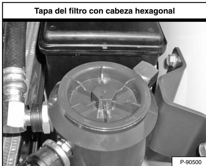
Este modelo tiene una cabeza hexagonal en la tapa del filtro **[Figura 284]**. (Ver Cómo desinstalar y reemplazar el filtro hidráulico / hidrostático (tapa del filtro con cabeza hexagonal) en la página 169.)
