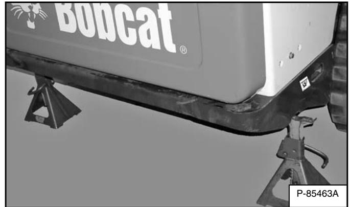
Instale los soportes debajo del extremo posterior del bastidor del cargador [Figura 197].
