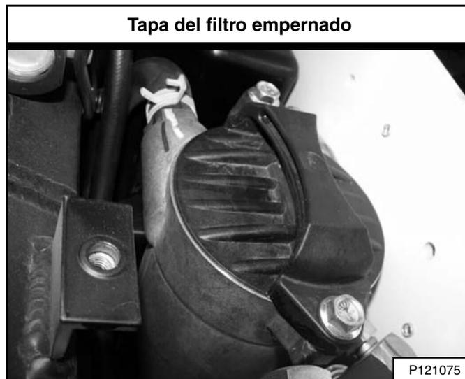
Este modelo tiene una tapa del filtro que se sujeta en su lugar con dos pernos **[Figura 286]**. (Ver Cómo desinstalar y reemplazar el filtro hidráulico / hidrostático (tapa del filtro empernado) en la página 171.)
