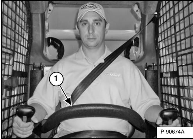
El sistema de restricción del asiento tiene una barra del asiento que hace pivote con descansa brazos (ítem 1) [Figura 36].
