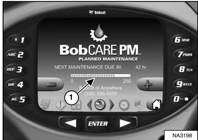
El panel de instrumentos de lujo (si está equipado) muestra una barra (ítem 1) [Figura 343] que muestra el tiempo restante para el siguiente servicio. Esta barra se vuelve roja cuando el servicio ya se debió haber hecho. La frase NEXT MAINTENANCE DUE (siguiente mantenimiento pendiente) se convierte en MAINTENANCE PAST DUE (mantenimiento en mora) y aparece el número de horas en mora.
