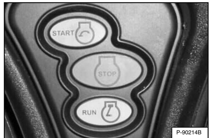
Los modelos anteriores usaban un conjunto de botones [Figura 19] en vez de un interruptor de llave.
