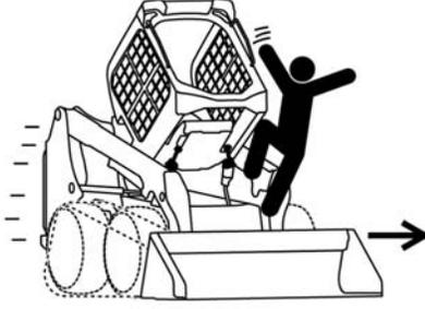
EL MOVIMIENTO INESPERADO DE LA CARGADORA, EL BRAZO DE ELEVACIÓN O EL ACCESORIO PROVOCADOS POR EL CONTACTO DE LA CABINA CON LOS CONTROLES PUEDEN PROVOCAR HERIDAS GRAVES O LA MUERTE
