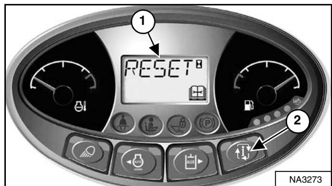
Oprima el botón de información (ítem 2) [Figura 344] hasta que la pantalla muestre el reloj de mantenimiento.
