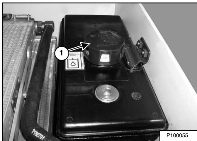
Retire la tapa de desfogue (ítem 1) [Figura 298] y descártela.
