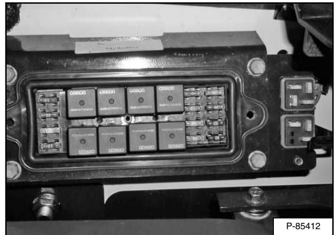
Retire las cubiertas para revisar o cambiar los fusibles **[Figura 267]**.
