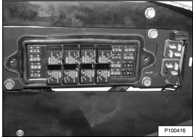
Retire las cubiertas para revisar o cambiar los fusibles [Figura 270].
