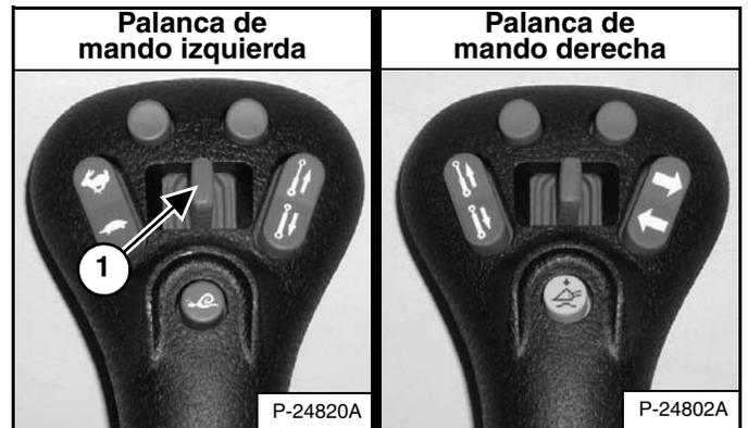
Mueva el interruptor de los auxiliares hidráulicos traseros (ítem 1) [Figura 99] o [Figura 100] hacia la derecha y izquierda varias veces.
