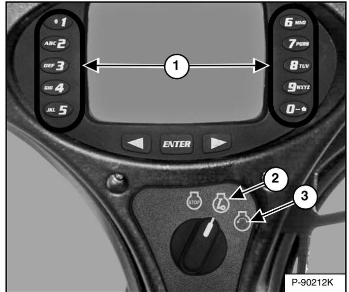
Gire el interruptor a RUN (ítem 2) [Figura 128]. Las luces indicadoras en el panel de instrumentos izquierdo se ENCENDERÁN brevemente y el panel de instrumentos / sistema de monitoreo efectuará una autoprueba.
