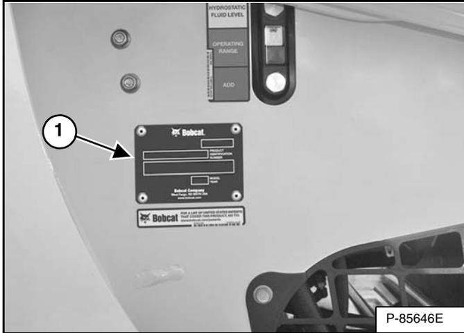
La placa con el número de serie del cargador (ítem 1) [Figura 1] está ubicada por fuera del bastidor.
