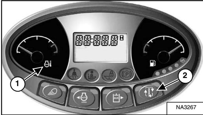
Monitoree frecuentemente los medidores de temperatura y combustible y las lámparas del BICSM<sup>MR</sup> (todas las lámparas del BICSM<sup>MR</sup> deben estar apagadas para operar el cargador) [Figura 132].
