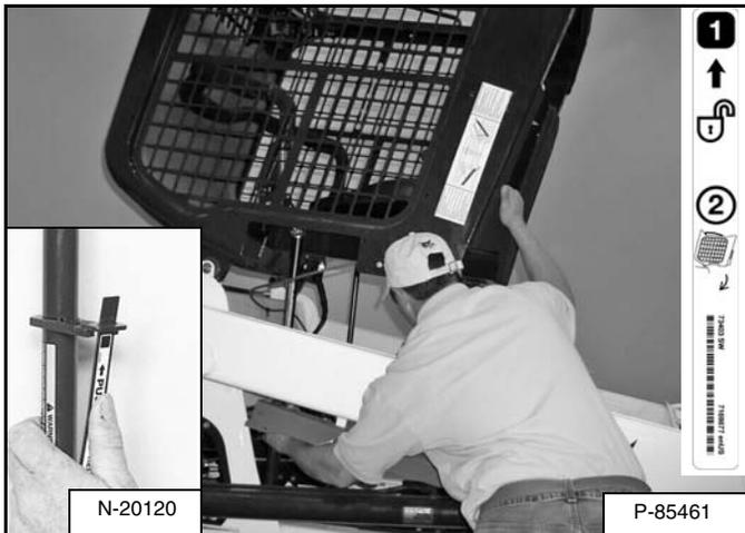
Tire hacia abajo el extremo inferior de la cabina del operador hasta que ésta se detenga en el mecanismo de seguridad [Figura 200].
