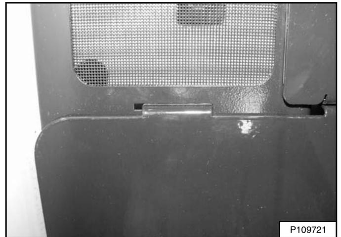
Alinee las lengüetas de la parrilla dentro de las ranuras en las dos cubiertas laterales [Figura 224]. (Se muestra el lado izquierdo).
