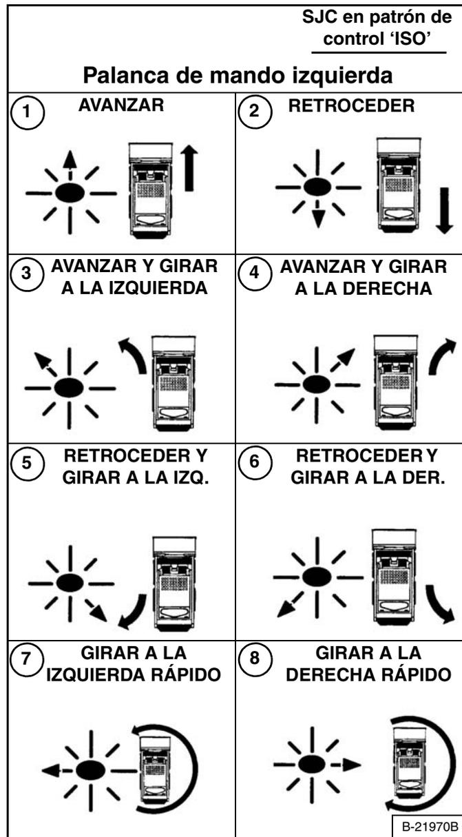
Funciones de la palanca de mando izquierda (manejo y dirección) [Figura 62].
