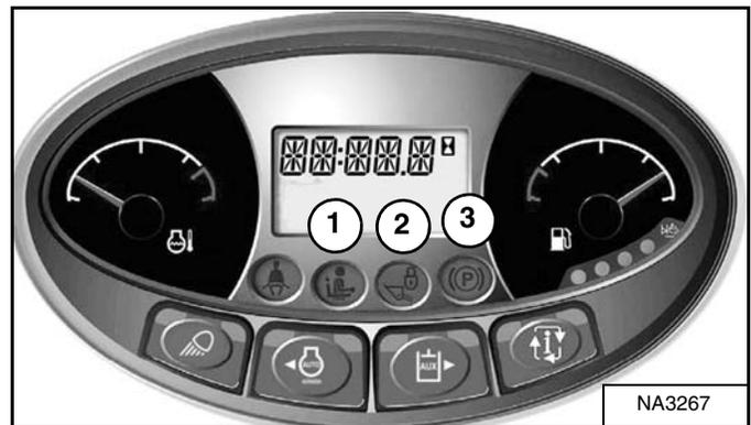
Hay tres lámparas (ítem 1, 2 y 3) [Figura 38] ubicadas en el panel de instrumentos izquierdo que deben estar APAGADAS para operar la máquina plenamente.
