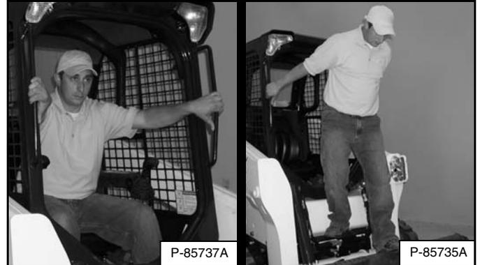
Salga del cargador usando las palancas de agarre, los peldaños de seguridad y los escalas (mantenga un contacto de tres puntos) [Figura 135].
